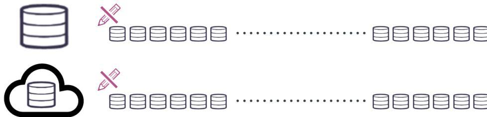
**仕様** : 特定の時点(例えば1時間間隔や1日間隔など)におけるディスクストレージの状態を複写(スナップショット)して時系列で複数のディスク状態を記録します。
